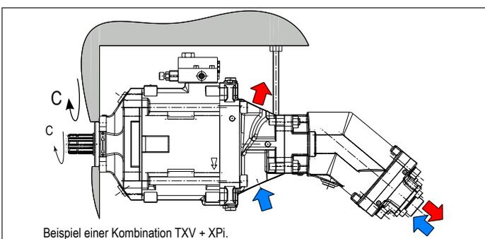
**Ein maximales Antriebsdrehmoment der Pumpe von 900 Nm darf nicht überschritten werden.**
