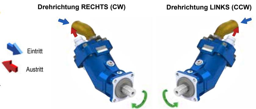
Montieren Sie den Saugstutzen der Pumpe an dem, der gewünschten Drehrichtung entsprechenden Einlass. Die Pumpe stellt sich dann automatisch auf die von Ihnen vorgewählte Drehrichtung ein.
