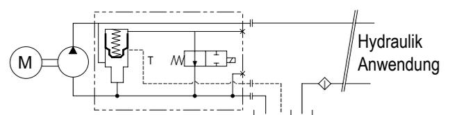
Eine Leckölleitung zwischen dem Bypass-Ventil und dem Hydrauliktank ist anzuschließen um ausreichende Kühlwirkung zu erzielen. Die Leckölleitung ist unterhalb des Ölspiegels am Tank anzuschließen.
