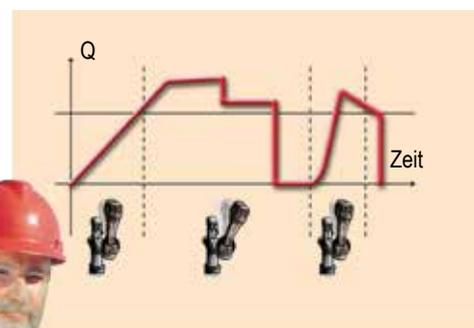
Die Position / Lagestellung des Proportionalventils wird ohne jegliche Verzögerung durch die Pumpe verarbeitet.
