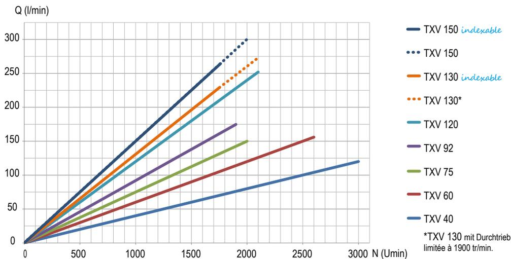
**⚠ Achtung : Die in der Drehrichtung umstellbaren TXVi Verstellpumpen sind begrenzt auf eine Maximaldrehzahl von 1.750 U/min.**
