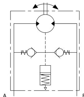
Bei **wechselnder Drehrichtung** ist der Motor zusätzlich mit einem Druckspeicher ausgestattet. Dieser Druckspeicher dämpft Druckspitzen (zum Beispiel bei abruptem Drehrichtungswechsel).
