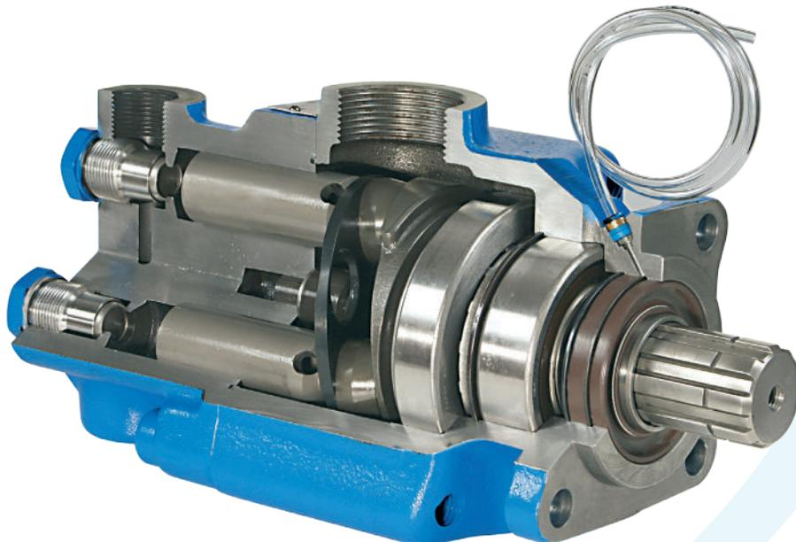
La gamme de pompes à pistons axiaux comprend deux séries : PA - PAC, toutes conçues pour des utilisations camion à des pressions jusqu'à 400 bar en continu et 500 bar en pointe.
