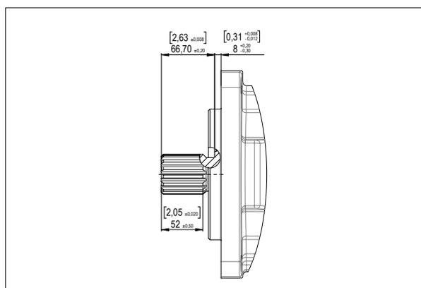
**Axe cylindrique à clavette Ø 2"**
